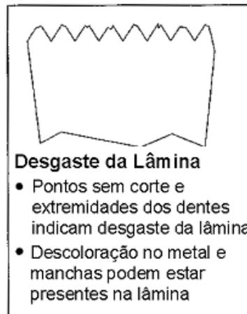
Arqueamento ou trincas na lâmina poderão causar sua ruptura e deixar suas partes no local da cirurgia ou ainda, agir como um projétil. Use sempre óculos de proteção quando operar peças de mão.
